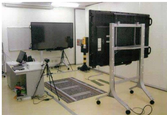
既存の列車見張員シミュレータの機能に加え、マツスイッチを使用した線路巡回訓練が可能です。また、実際の業務で発生しうる異常時を想定した、踏切支障報知装置や非常停止ボタンによる列車防護訓練ができます。
