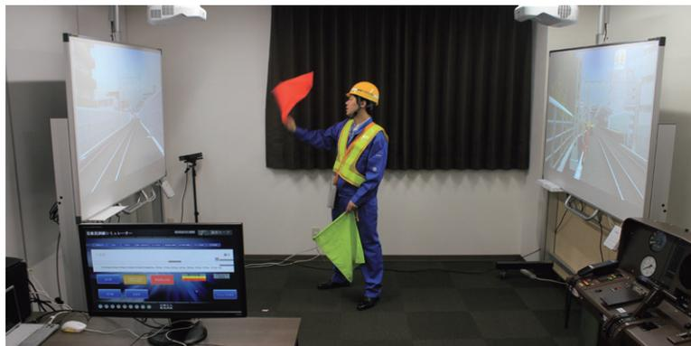
訓練者が出す合図はセンサーにより判定され、正しい合図の出し方を訓練できます。
