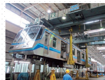
台車取り付け作業
