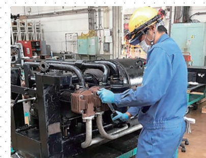
コンプレッサー整備作業
