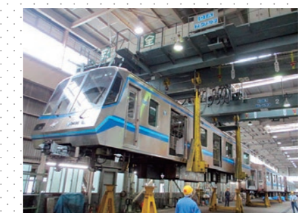
台車取り付け作業
