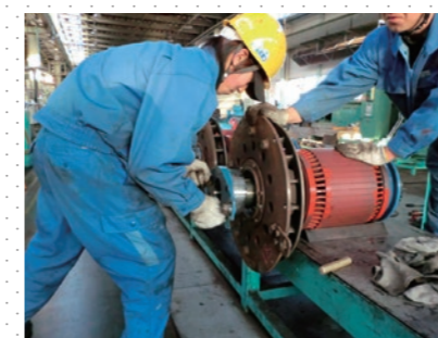
主電動機組み立て作業
