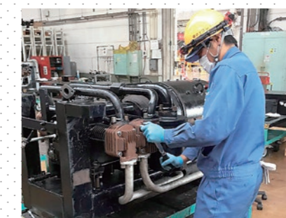
コンプレッサー整備作業
