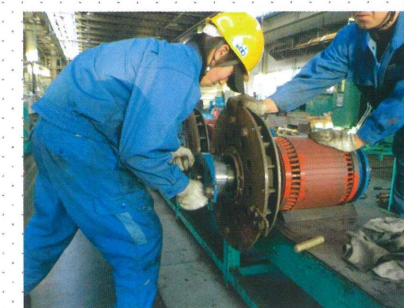
主電動機組み立て作業
