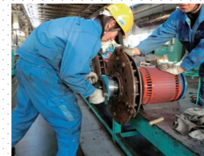
主電動機組み立て作業
