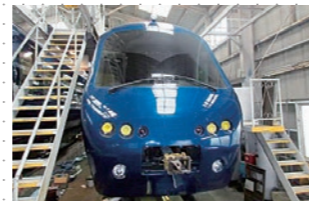
前面愛称表示機埋設(後)
